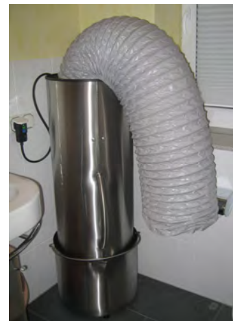
Bild 5 AirClean mit Ausblasöffnung in die Ecke gedreht
